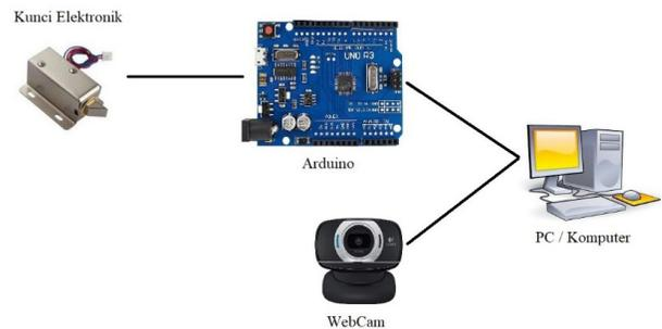
Fig 7. Diagram Blok
